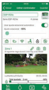
Aplicación Móvil de Rain Bird®, Menú de visualización de ajuste estacional automático, el cual puede ser accionado o no según las necesidades del riego, generando ahorros de agua.
