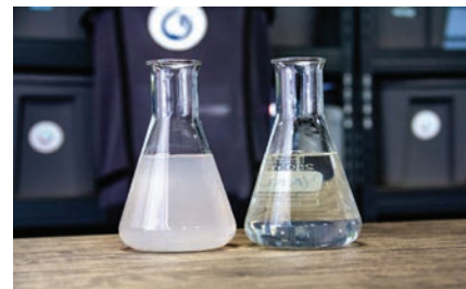
Imagen 3: Comparación del agua gris antes y después de ser tratada con biofiltro Yaku®.
