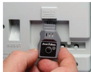
Conexión a accesorio Módulo LNK WiFi (conectividad inalámbrica) de Rain Bird®
