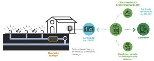
Imagen 4: Esquema de funcionamiento del sistema my2DROPS en una instalación domiciliar
